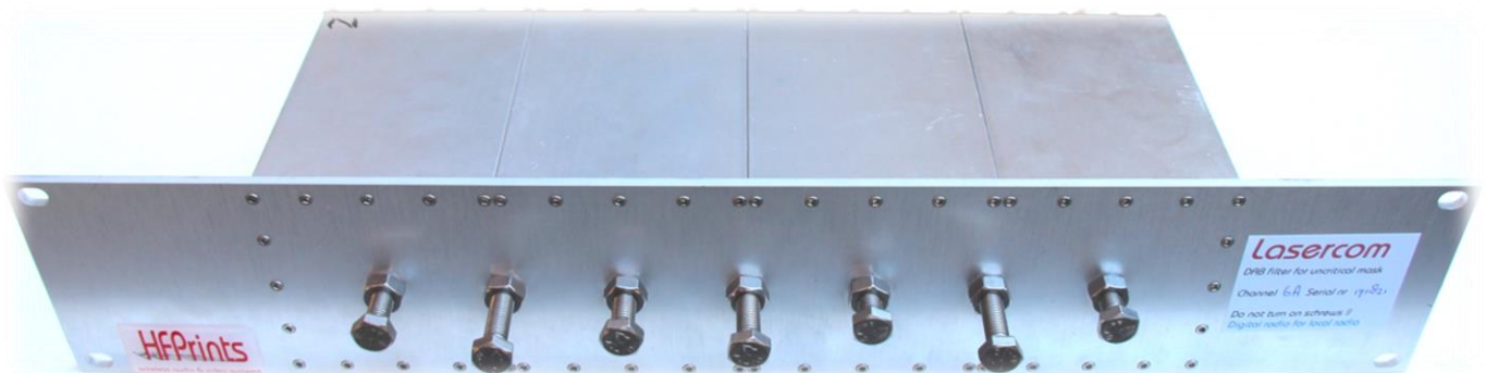
Foto boven, het DAB uncritical mask filter, 4 krings helical filter.
