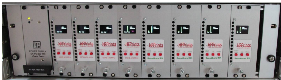
Boven: ontvangst rack voor 4x WZ, links de voeding. Dan 4x retour zender 415 / 430 en 4x diversity ontvanger 174 – 230 MHz.
